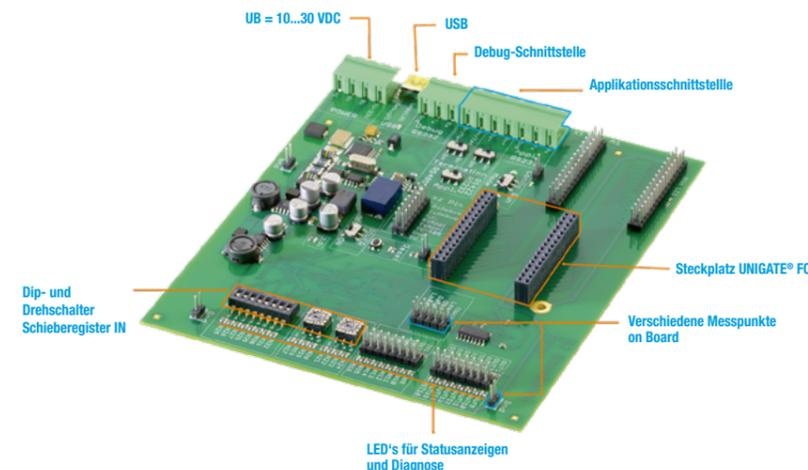
Das Add-On wurde konzipiert um eine einfache Master-Simulation zur Verfügung zu stellen.
